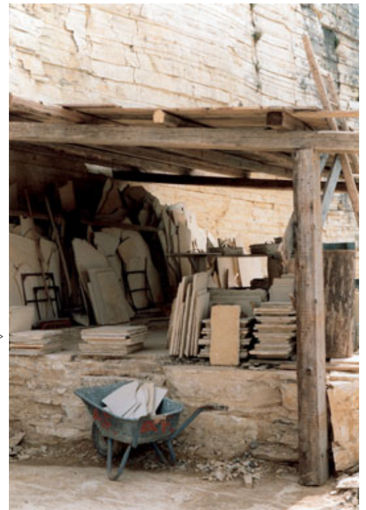
3.14. Das Zurichten und Formatieren der Steinplatten wird noch im Steinbruch mit Hämmern und Zangen vorgenommen. Im Sommer schützen sich die Arbeiter vor Sonne und Regen unter einem einfachen Dach, im Winter in abgeschlossenen und beheizten Werkhütten.
